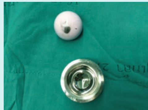
รูปที่ 6 Retrievals : ceramic head (Biolog delta) and metal insert (Pinnacle)
